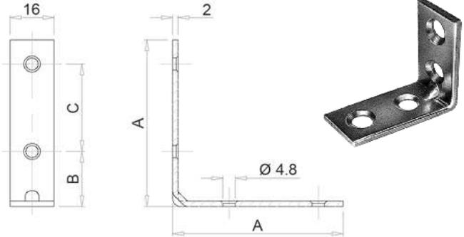
Толщина стальной полосы 2 мм
